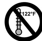
Utilice y almacene la batería únicamente en un intervalo de temperaturas de -10 °C (14 °F) a no más de + 50 °C (122 °F). Proteja la batería de la luz solar directa.
