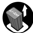
Retire la batería de la herramienta motorizada. Esto evita el riesgo de que el motor arranque inesperadamente.
