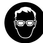
Para reducir el riesgo de lesionarse los ojos, nunca maneje la herramienta motorizada si no tiene puestas gafas o anteojos de seguridad bien ajustados con una protección adecuada en las partes superior y lateral que satisfagan la norma ANSI Z87 "+" (o la norma nacional correspondiente).
